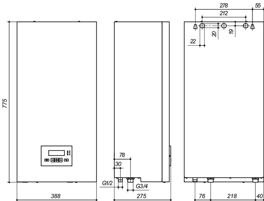
**Рисунок 11. Габаритные и присоединительные размеры прибора**
